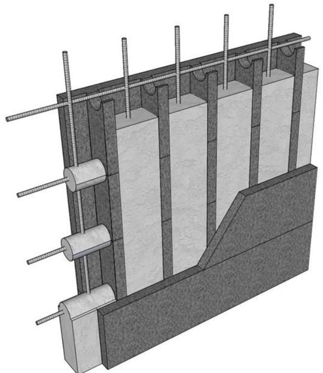
La grilla de hormigón armado resultante en el Interior de los módulos permite altísimas resistencias estructurales incluso aptas para zonas sísmicas según la norma INPRES-CIRSOC 103.
